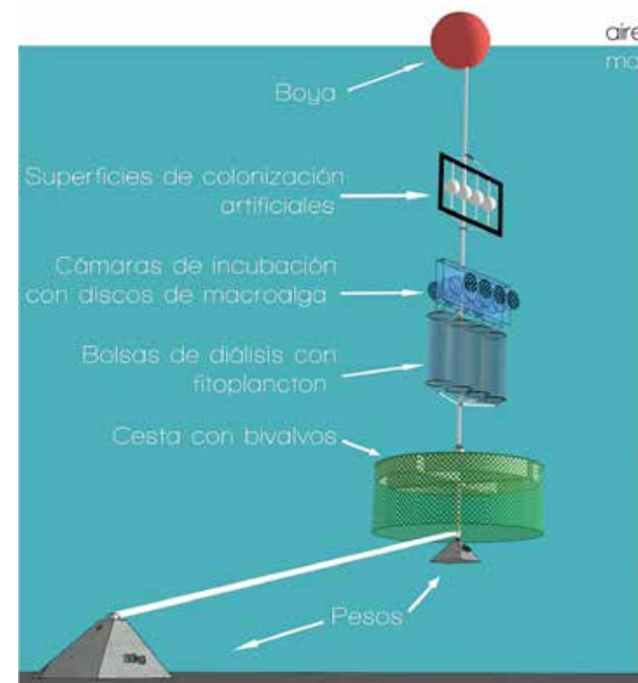
Figura 7.8. Esquema do dispositivo utilizado por Carballeira (2013) para a realización de múltiples bioensaios in situ para a vixilancia ambiental das piscifactorías mariñas instaladas en terra na zona litoral de Galicia.
