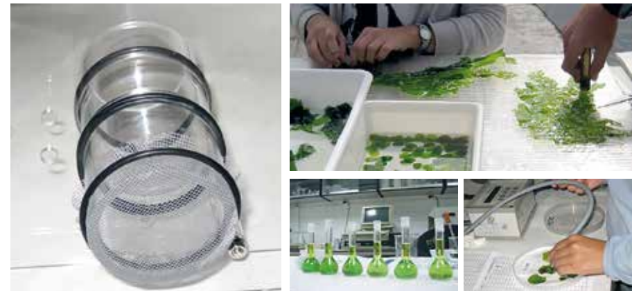
Figura 7.11. Cámara de metacrilato cilíndrica con peches de malla de 1mm de poro para a exposición de discos algais (Esquerda). Obtención dos discos con sacabocados e procesado despois da súa exposición (determinación de biomasa, análise pigmentario e fluorescencia clorofílica) (Dereita).
