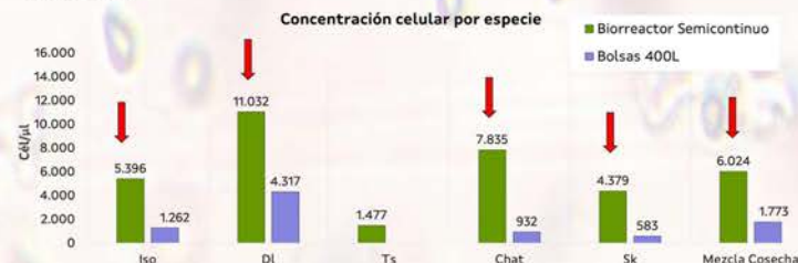
Fig 2: Concentraciones celulares (cél/µl) de las especies analizadas y de la mezcla de la cosecha, en los dos sistemas evaluados en el Cima de Corón (fotobiorreactor en semicontinuo y bolsas de 400L en continuo).
