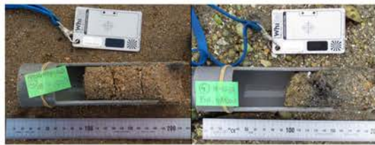
Figura 1. Fotografías tomadas a dous dos perfís de sedimento no momento da súa recollida. Á esquerda sedimento limpo, á dereita sedimento con manchas de redución.
