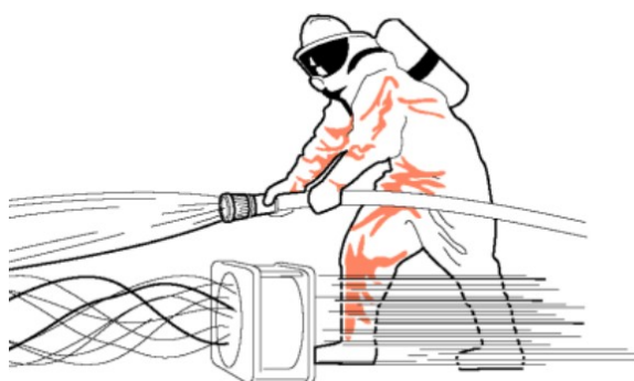
Sistemas de ventilación forzada
