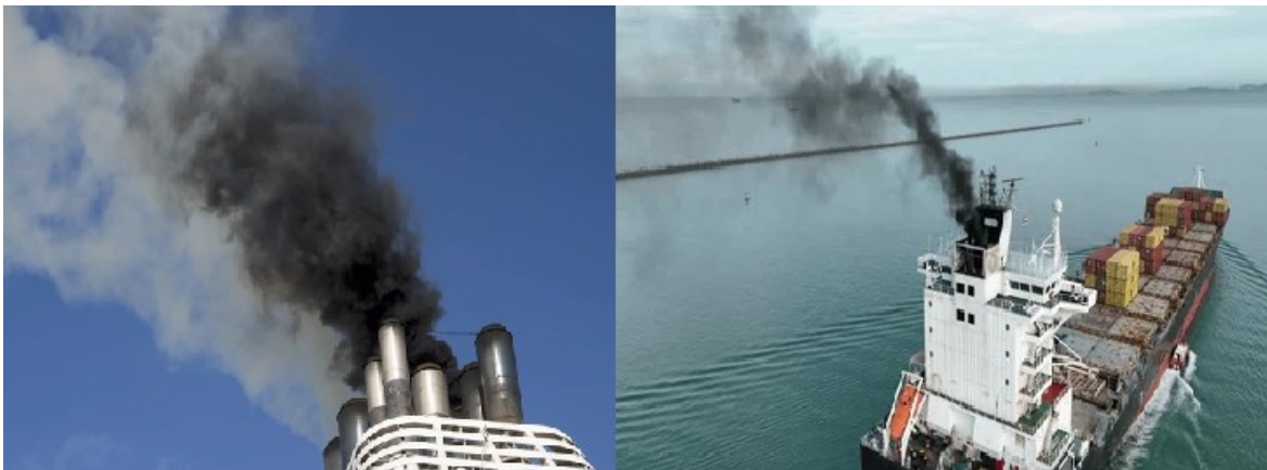
Activación sopladores hollín
