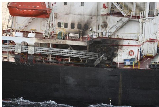
Incendio eléctrico a bordo
