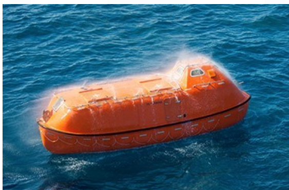
Sistema de rociadores contra-incendios bote salvavidas
