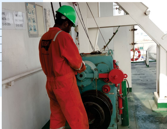
Freno maquinilla/chigre puesta a flote bote salvavidas
