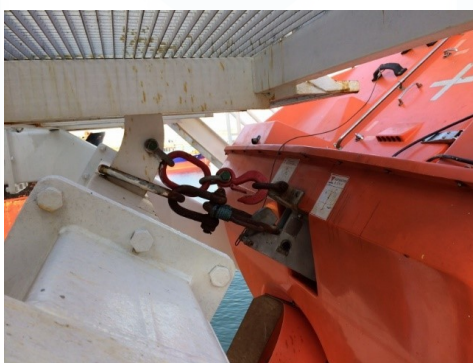
Mecanismo de gancho bote de caída libre
