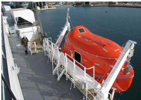
Puesta a flote y pescante bote salvavidas
