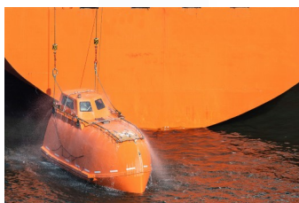
Rociadores de agua bote salvavidas
