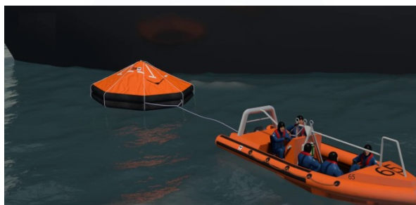
Remolque de balsa salvavidas desde bote de rescate
