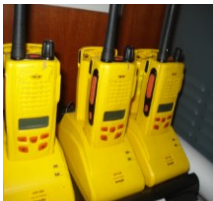
VHF portátiles del SMSSM
