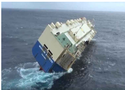
Buque Car Carrier escorado por corrimiento de carga
