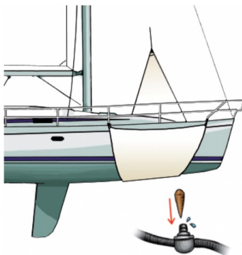
Técnica de la vela y espiche para taponar vías de agua o fugas
