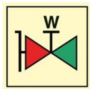
Señal OMI Bocas contra incendios
