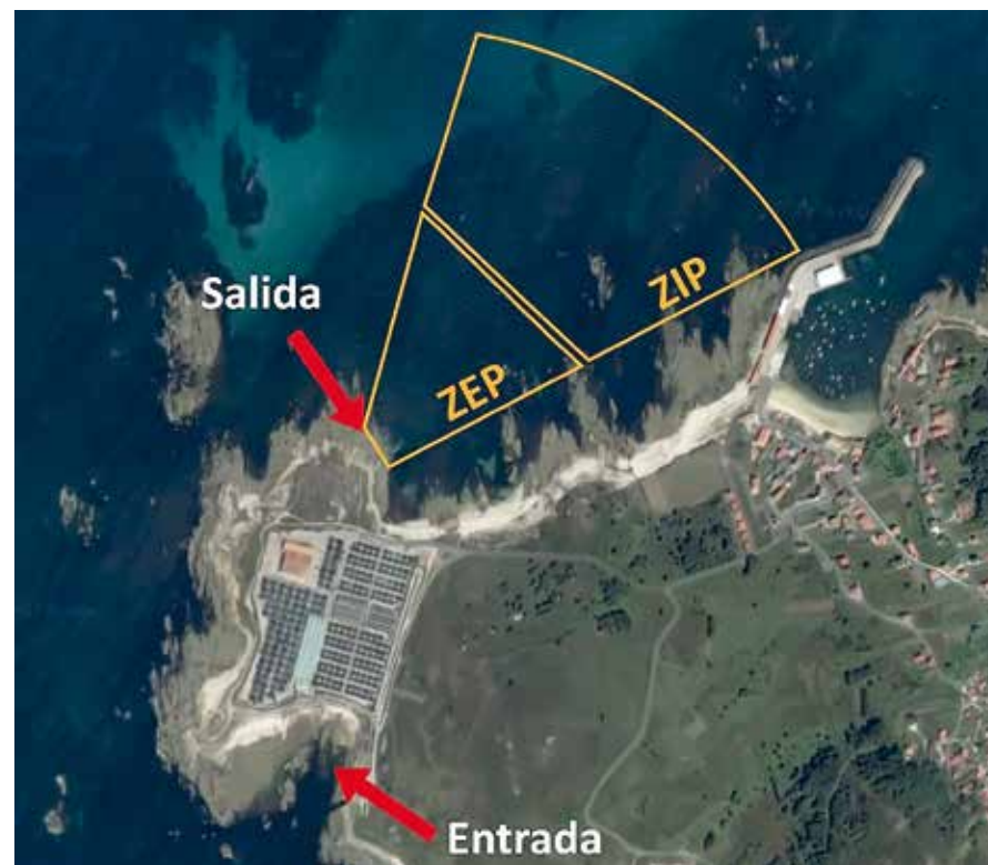
Ejemplo de delimitación de ZEP y ZIP basada en la señal isotópica \delta^{15}\text{N} detectada en el bioensayo de crecimiento de discos de macroalgas (ver figura 7.13).
