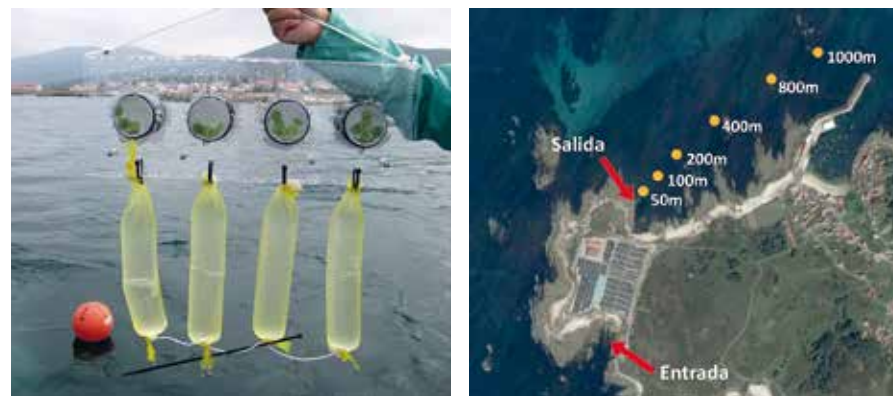
Figura 7.9. Dispositivo de trasplante, consistente en un bastidor de metacrilato, con cuatro cámaras para la incubación de discos de macroalgas, del que cuelgan cuatro bolsas de diálisis, protegidas con malla de nylon amarilla, y que contienen muestras de la comunidad fitoplanctónica nativa (Izquierda). Gradiente de exposición a los vertidos de una piscifactoría marina instalada en Lira (A Coruña) donde se situaron los dispositivos experimentales (Derecha).
