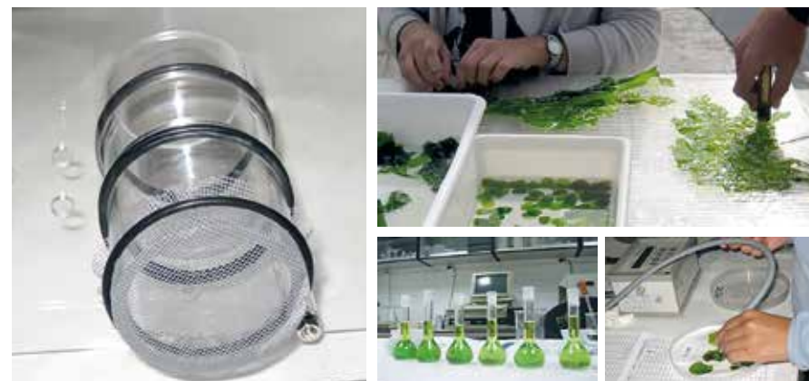
Figura 7.11. Cámara de metacrilato cilíndrica con cierres de malla de 1mm de poro para la exposición de discos algales (Izquierda). Obtención de los discos con sacabocados y procesamiento después de su exposición (determinación de biomasa, análisis pigmentario y fluorescencia clorofílica) (Derecha). Foto: A. Carballeira.
