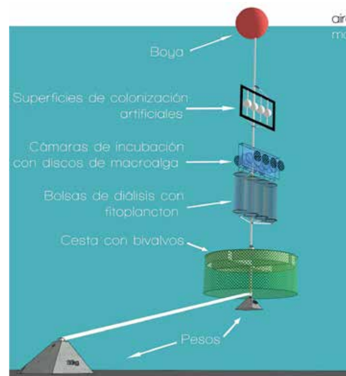
Figura 7.8. Esquema del dispositivo utilizado por Carballeira (2013) para la realización de múltiples bioensayos in situ para la vigilancia ambiental de las piscifactorías marinas instaladas en tierra en la zona litoral de Galicia.
