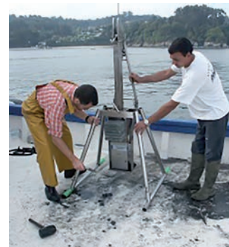
Muestreo del bentos con una draga tipo Box-Corer (Foto. Dr. José Mora Bermúdez)
