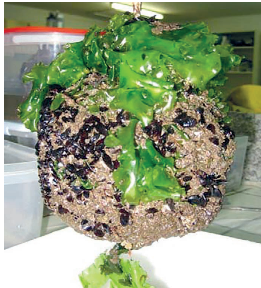
El fouling es capaz de colonizar rápidamente todo tipo de sustratos artificiales depositados en el mar. Estado de una boya experimental después de un par de meses de exposición en el mar de Lira (A Coruña). La boya está totalmente cubierta de algas oportunistas ( Ulva sp.), mejillón ( M. galloprovincialis ) y arneirón ( Balanus sp) (Foto. Dr. Carlos Carballeira Braña)
