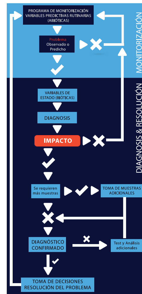
Figura 1. Esquema del protocolo de un plan de vigilancia ambiental continuo de las piscifactorías marinas en jaulas
