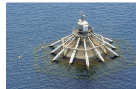
Figura 9. Actualmente, es muy aventurado realizar en Galicia acuicultura en mar abierto por su alta energía. Ejemplos de instalaciones experimentales capaces de soportar condiciones de mar extremas (Tomado de: FAO. 2010)
