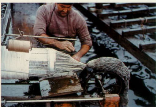
Encordado del mejillón a máquina, con red tubular.
