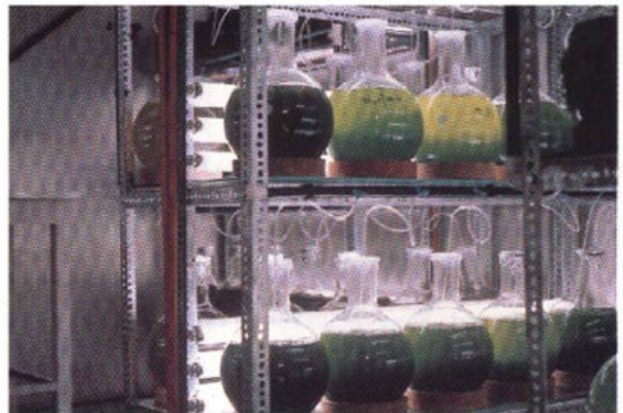
Reactores de 6 l utilizados en el cultivo moespecifico de fitoplancton.
