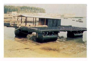
Batea de 4 flotadores cilíndricos
