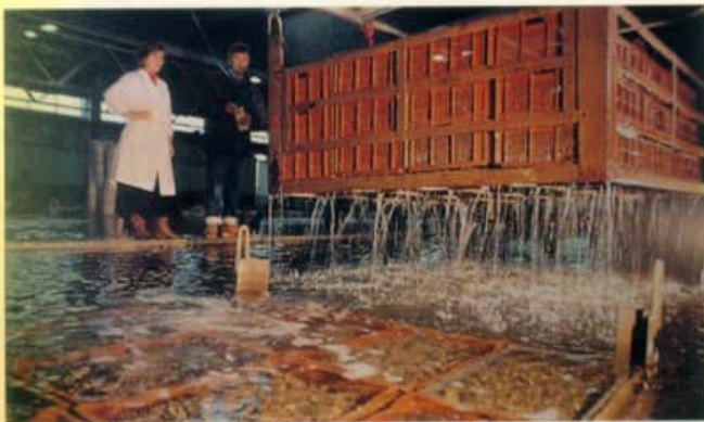
Izado de cestas en una depuradora.
