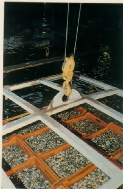
Estructura para izado de cestos en una depuradora
