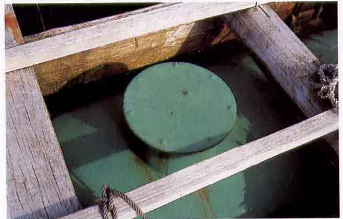
**Flotador cilíndrico en la estructura del emparrillado.**
