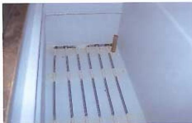
**Rejilla de aireación de un tanque del camión vivero.**
