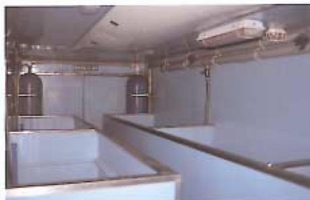
**Interior de un camión-vivero.** Obsérvese el sistema de tanque, el sistema de frío y las conducciones de agua.
