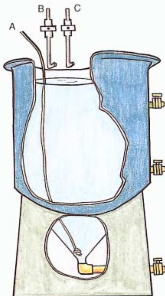
Esquema de un tanque para cultivo de rotífero A. Aire. B. Agua Salada. C. Fitoplancton.
