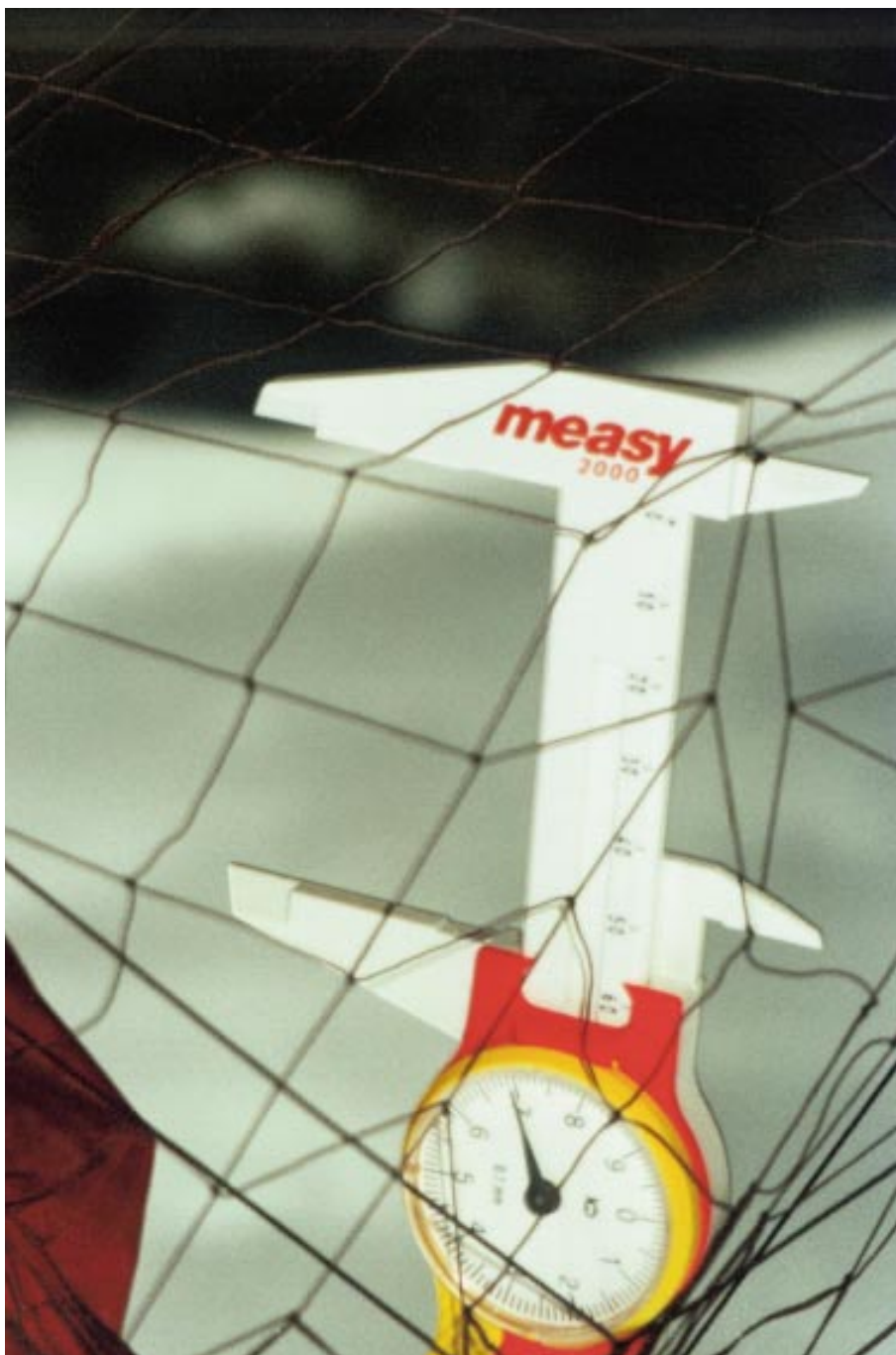
Foto 1 - Medición con calibre da abertura de malla do pano interior do trasmallo.
